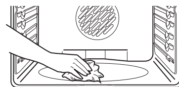
Limpie con un paño los desechos rebeldes acumulados en el piso del horno.
