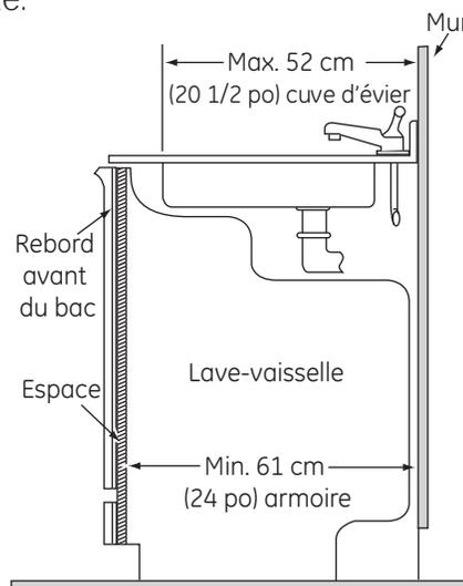
**Remarque.** - Il peut y avoir un espace entre le rebord avant du bac du lave-vaisselle et l'avant de l'armoire si la profondeur de l'armoire est moins de 61 cm (24 po) ou si la cuve d'évier n'a pas été installée selon les directives.
