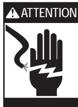
**ATTENTION** SÉCURITÉ : Enlever les fusibles ou débrancher le disjoncteur de la maison avant de commencer l'installation. Ne pas utiliser une rallonge ou un adaptateur de prise avec cet appareil.
